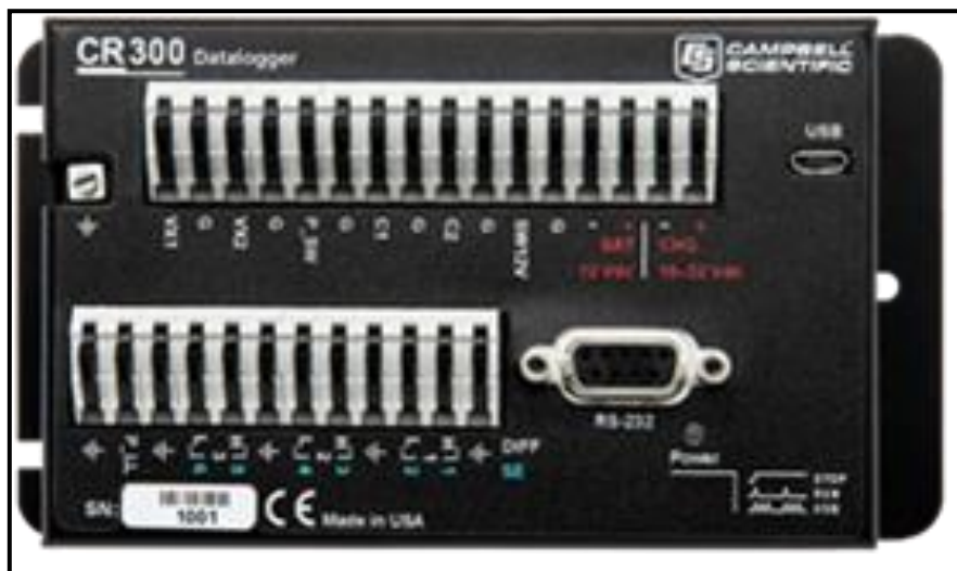
Fig. 3.20. CR 300 Data Logger
