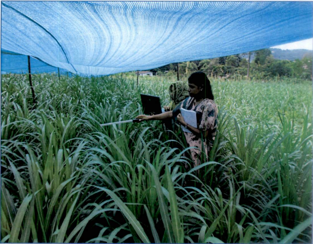
Plate 2. Measuring PAR readings using canopy analyser
